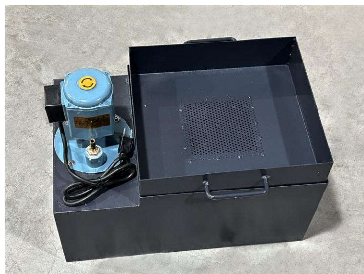
高速切削中，冷却系统通过循环冷却液来降低工件和切削刀具的温度，有效地带走热量，保障工件质量、延长刀具寿命、提高加工效率。
