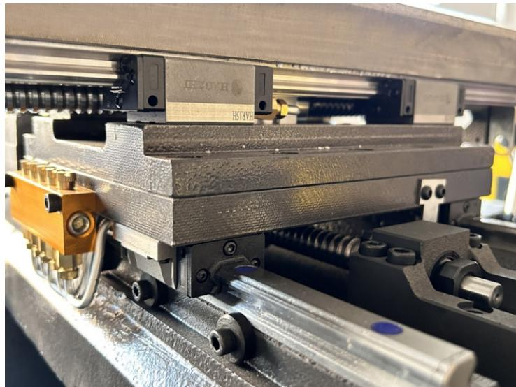
床身本体选用优质铸造材料，钢性更好，更稳重；采用高精度工业级直线导轨，运行速度更快更丝滑；采用研磨滚珠丝杆，精度更高；配有润滑系统，用于导轨和丝杆的润滑，提高机床寿命，保障机床的精度。
