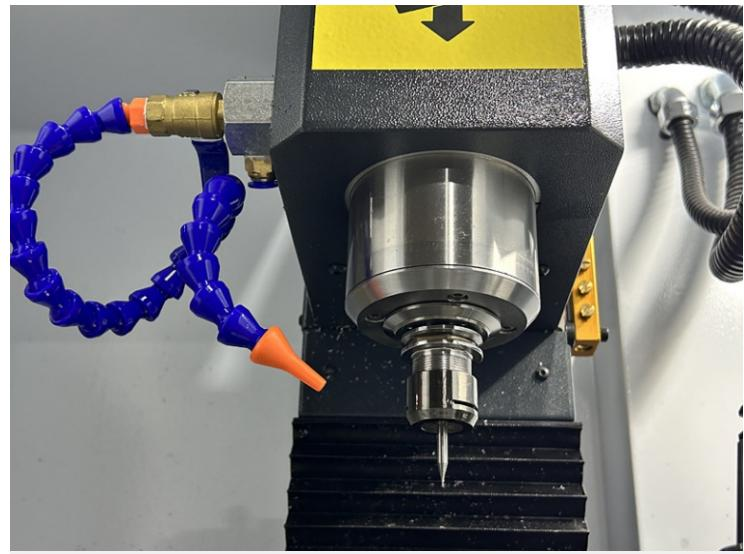
配置ISO20变频水冷高速主轴，功率2.2KW，低噪音，最高转速达24000rpm，主轴锥孔跳动精度达2um,配有主轴冷却循环系统;可以用于雕刻、铣削、钻孔加工；加工零件表面光洁度高。
