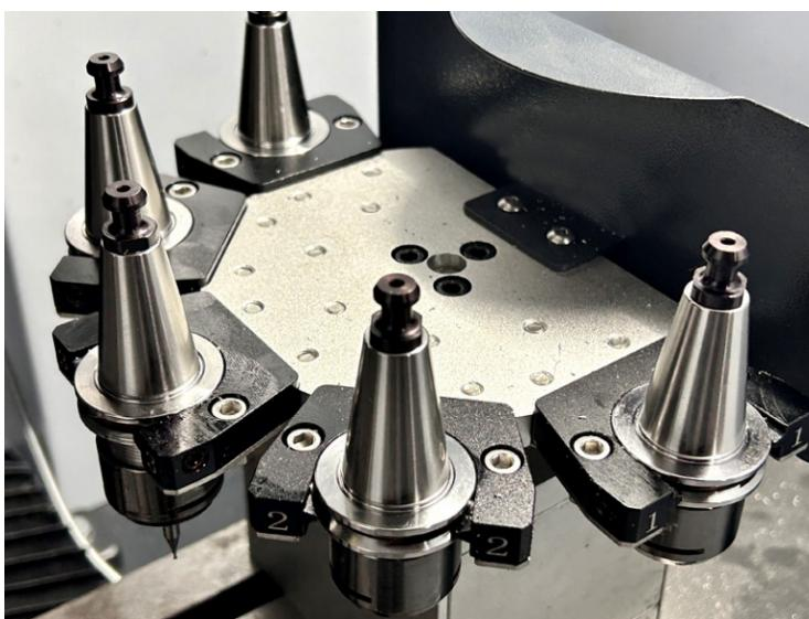
配置5工位电动刀库，可以完成各种不同的加工需求，如铣削、钻孔、雕刻等，大幅缩短加工时程；刀库转盘设计有防尘罩，可确保加工过程的残渣掉入刀柄上，影响换刀过程。
